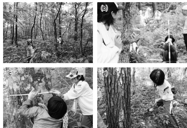
図3 樹木の測定 (a) 測高竿の使い方、(b) 超音波測音器の使い方 (c) 直径割巻尺の使い方、(d) 成長錐の使い方。
